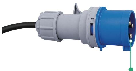
工业用插头, 2P+E, 32 A, 250 V AC, IP44, 符合欧洲/国标标准 EN/IEC 60309-2
