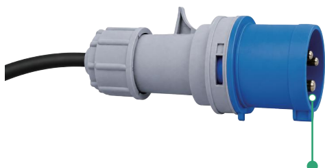
工業用插頭，2P+E，32 A，250 V AC，IP44，符合歐洲／國標標準 EN/IEC 60309-2
